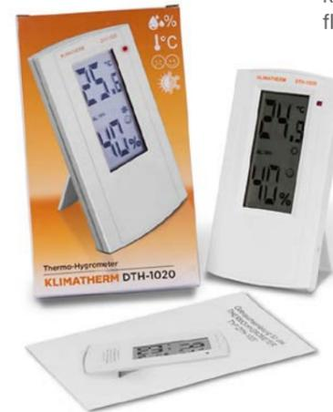
Neben der Temperatur- und Feuchteanzeige befindet sich auf der Vorderseite des DTH-1020 eine rote Leuchtdiode, die in der Wintereinstellung bei einer relativen Feuchte ab 60 %, 55 % oder 50 % anfängt zu blinken. Die Alarmgrenze kann auf der Rückseite umgestellt werden und wird auf dem Display angezeigt (z. B. AL: 55 %)
